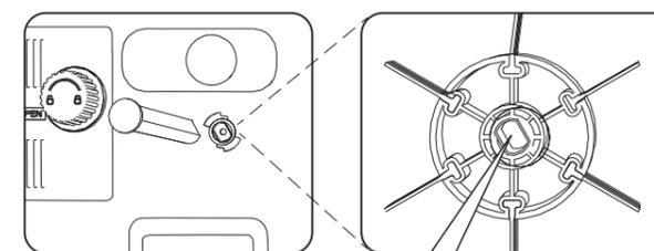
ストッパーと羽根車の穴の形状に注目して取り付けてください。
